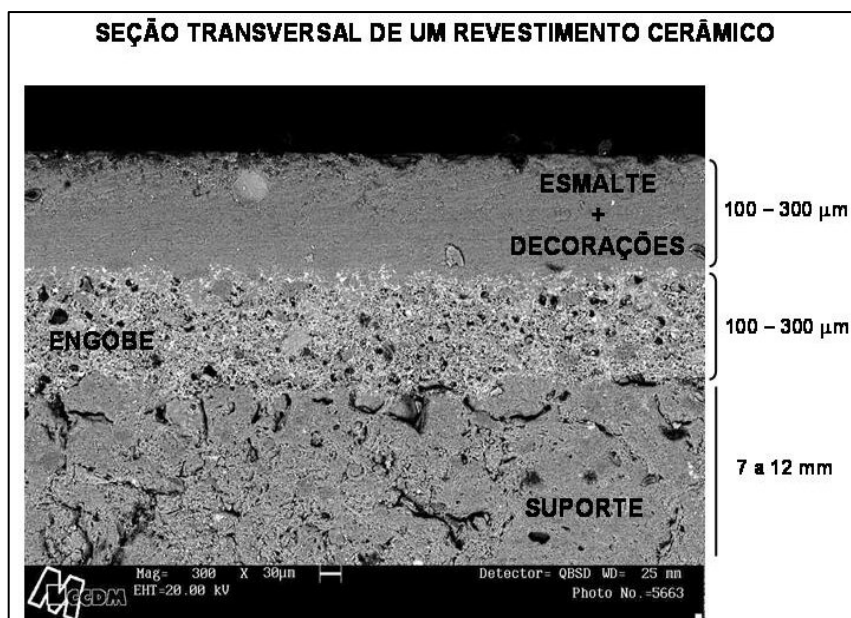
Figura 21 - Seção transversal de uma placa de revestimento cerâmico.
